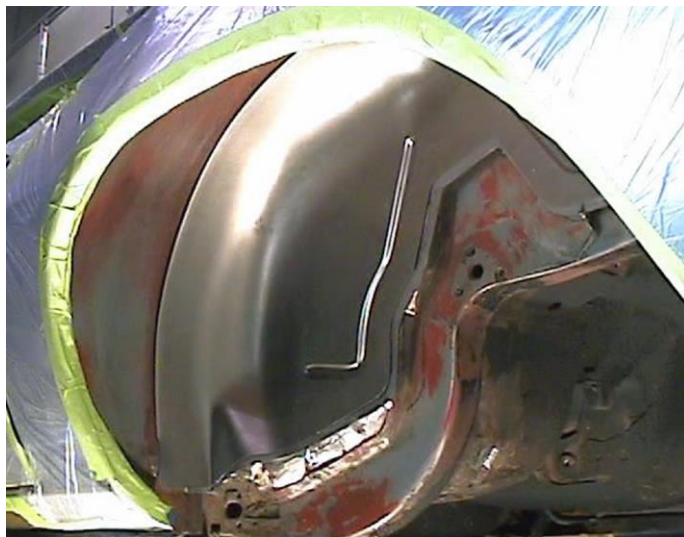
Figure 15 – Test Fit DSE Mini Tub
