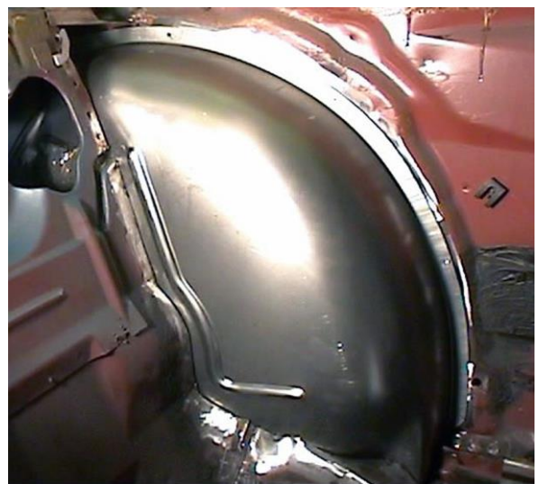
Figure 15 – Test Fit DSE Mini Tub
